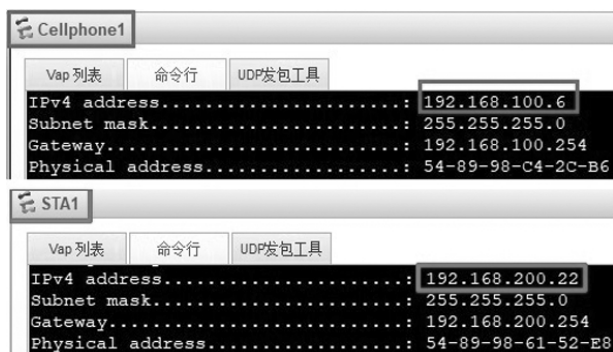
图 3 移动节点 Cellphone1 和 STA1 自动获取的 IP 地址
